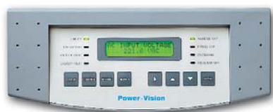
Панель управления и контроля
